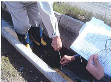
←トラフ断面 測定
